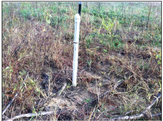
M3 crest gauge STA 55+50
